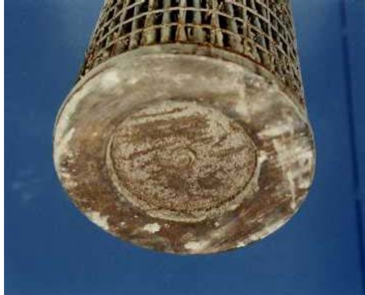
Bild 6: Korrosion am Boden der Filterpatrone
