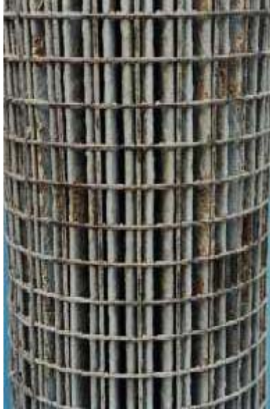
Bild 5: Korrosion des Metallgewebes
